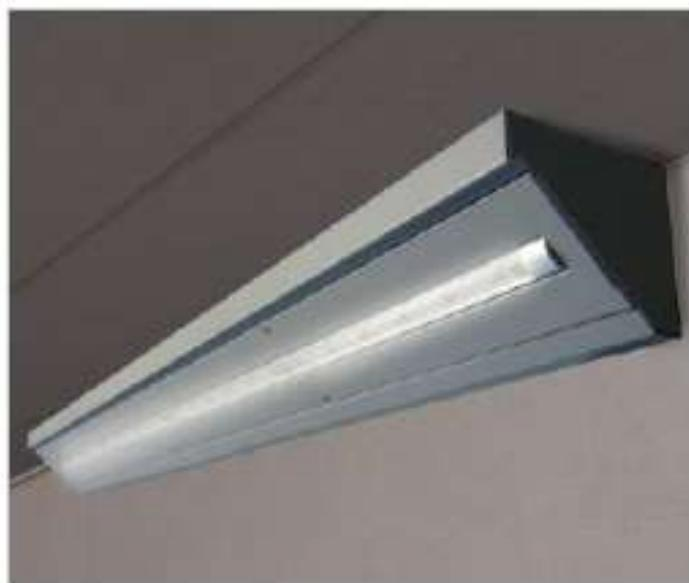
Apparecchio a soffitto di illuminazione a luce diretta a LED con protezione interna anti inversione di polarità. Apparecchio illuminante modulare in alluminio dalla caratteristica forma a "Neon". Carter in lamiera zincata e verniciata. Barra AVLed lunghezza 1200mm. Tinte Ral varie. Alimentazione possibile sia in corrente alternata tramite alimentatore oppure in corrente continua da impianti fotovoltaici.
